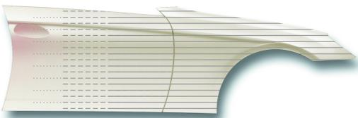
Den zweiten Effektgang auftragen und über den Rand der vorhergehenden Schicht in das angrenzende Teil beilackieren. Zum Beilackieren die Tröpfchen-Technik mit reduziertem Druck einsetzen.
