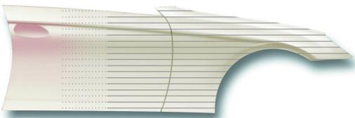
Das beizulackierende Teil leicht mit einem grauen Pad schleifen, um - falls erforderlich - den Spritznebel zu entfernen. Sofern gewünscht, Stadox Basecoat Colourless auf das angrenzende Teil auftragen. Den ersten Spritzgang des Effektfarbtons auf den Grundfarbton auftragen und über den Rand des zuvor aufgetragenen Grundfarbtons hinaus in das angrenzende Teil beilackieren. Zum Beilackieren die Tröpfchentechnik einsetzen. Ablüften lassen.
