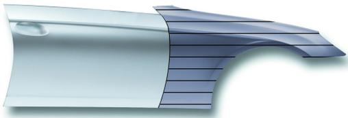
Reparaturzone mit Stadox Basislack in einzelnen Spritzgängen
