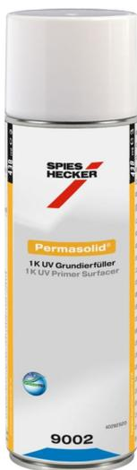
Der leicht transparente Permasolid 1K UV Grundierfüller 9002 eignet sich für die sehr schnelle Reparatur von kleinen Schadstellen und Speed Repairs. Die Trocknung erfolgt mit handelsüblichen HID Quecksilber Lampen oder UV-A Licht emittierenden LED Lampen mit ausreichender Intensität im Wellenlängenbereich von 360-400 nm.
