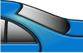
Den Auslaufbereich mit einem groben Poliermittel polieren und alle Rückstände abwischen. Den Übergang zur Schadenstelle z.B. mit 3M Trizact P3000 Feinschleifscheiben oder ähnlichen Schleifmitteln anderer Hersteller schleifen. Den vorbereiteten Bereich mit Standox Reiniger 6800 reinigen.
