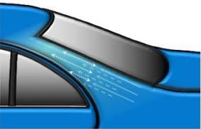
Beispritzen des reinen Performance Blend 5730 in dünnen Spritzgängen auf die polierte Bleilackierzone (bei Verwendung der Spritzpistole, Druck reduzieren).
