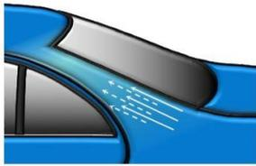
Standocryl VOC-Performance-Pro-Klarlack K9590 oder Standocryl VOC Xtreme Plus Clear K9600 gemäß Technischem Datenblatt einstellen. Die geeignete Standox Basislackqualität mit spritzfertig eingestelltem Standocryl VOC-Performance-Pro-Klarlack K9590 oder Standocryl VOC Xtreme Plus Clear K9600 überlackieren. Den Klarlack in abgestuften Spritzgängen mit reduziertem Spritzdruck beilackieren in den geschliffenen Bereich und bis zur Kante des polierten Bereichs.
