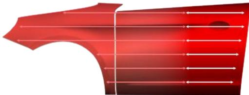
Zwei Spritzpistolen oder Einwegbecher verwenden, um schnell arbeiten zu können. Den ersten Spritzgang des eingefärbten Klarlacks auf den Reparaturbereich auftragen und in das angrenzende Teil auslegen. Sicherstellen, dass über den Rand des zuvor aufgetragenen Basislackfarbtons hinaus lackiert wird. Direkt im Anschluss den ersten Spritzgang des nicht eingefärbten Klarlacks auf dem angrenzenden Teil am weitesten auslegen und in die eingefärbte Klarlackschicht einlackieren. Ablüften lassen.
