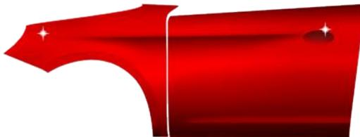
Eine weitere Schicht des nicht eingefärbten Klarlacks über den gesamten Reparaturbereich wird zur Vereinfachung der anschließenden Polierarbeiten empfohlen. Längere Materialeinstellungen, Ablüft- und Trockenzeiten sind zu berücksichtigen. Den Klarlack gemäß Technischem Datenblatt trocknen.
