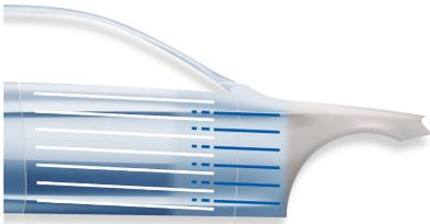
Standoblue Basecoat in einem Spritzgang bis zum Rand der Standoblue-Color-Blend-Schicht auftragen und in den angrenzenden Bereich / das angrenzende Teil ausweiten. Anschließend einen Effektgang in die nasse Standoblue Color-Blend-Schicht beilackieren.
