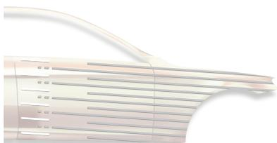
Als ersten Spritzgang den Standoblue Perleffekt-Farbton bis zum Rand des noch nassen Standoblue Color Blend / Color Blend lang auftragen. Vom weitesten Punkt ausgehend, von innen nach aussen arbeiten. Weitere Spritzgänge sollten wie erforderlich innerhalb der vorhergehenden Schicht aufgetragen werden, um die Reparatur abzuschließen und den Farbton anzupassen. Die gesamte Applikation erfolgt nass-in-nass. Abluft und Trocknung der gesamten Oberfläche wie auf der vorigen Seite beschrieben.
