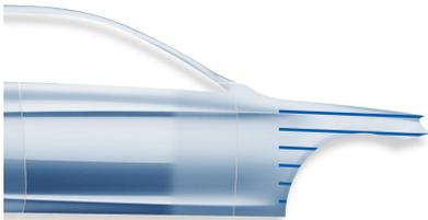
Standoblue Basecoat im normalen Verfahren mit 1,5 Spritzgängen auf den Reparaturbereich (Füller) auftragen. Spritzdruck 1,5 - 2,0 bar.
